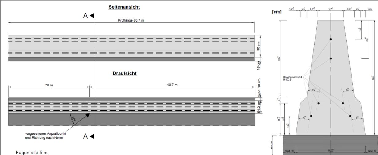
Kennzeichnend für die zweiseitige BSWO LT 103 ME ist, dass sie in Ortbetonbauweise im Step Profil mit einem Gleitschalungsfertiger hergestellt wird. Die Anprallprüfung erfolgte mit einer 16cm hohen Asphalt Unterlage. In der frei aufgestellten BSWO ist eine 6-fache Längsbewehrung – im BSWO Fuß Bereich symmetrisch verteilt - vorhanden.
